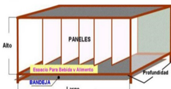
Figura 4. Esquema de jaula utilizada en la cría intensiva de caracoles.
