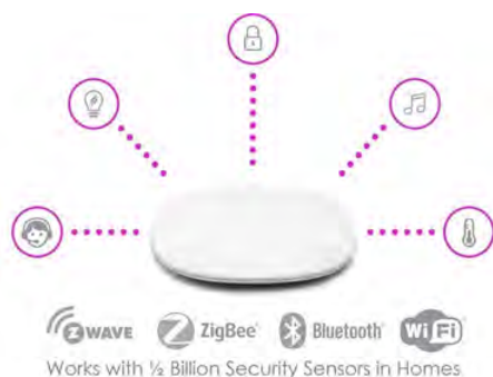
Figura 3. Infraestructura de puerta de enlace en una casa inteligente.
