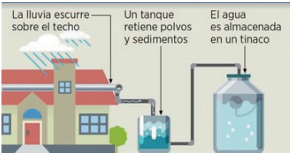
Figura 6. Sistema de recolección de agua de lluvia, en la que se utiliza el techo de una construcción como colector. El agua recolectada pasa a un filtro, y de allí a un tanque almacenador [11].
