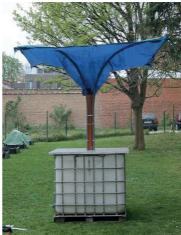
Figura 5. Sistema portátil de recolección de agua de lluvia. La parte superior es una lona de forma cónica, que sirve para recolectar la lluvia, la cual es conducida a través de un tubo hacia un tanque de almacenamiento colocado en la parte inferior y que a su vez sirve como base de sustento al colector [10].
