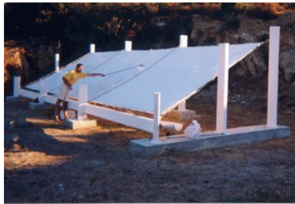
Fig. 10. Colector de rocío de 3 x 10 m, en Ajaccio, Isla de Córcega, Francia. F: película; T: tanque recolector de agua. La flecha indica la dirección de los vientos nocturnos dominantes (NE). (Fog Newsletter, Jun 2002, n° 7).
