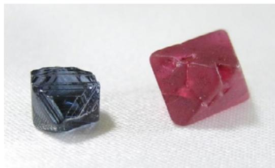
Figura 7. Ejemplo de espinela de magnesio y aluminio (gris) y óxido de aluminio (rojo) (Wikipedia.org, 2022).
