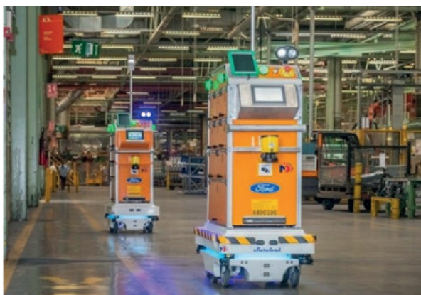
Figura 3: Robots MiR empleados para optimizar la logística interna en FORD España. (MiR robots help FORD Spain, 2023).
