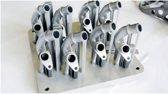
Figura 6: Conectores de agua fabricados mediante manufactura aditiva para el motor Audi W12. (Volkswagen identifies key areas, 2018)
