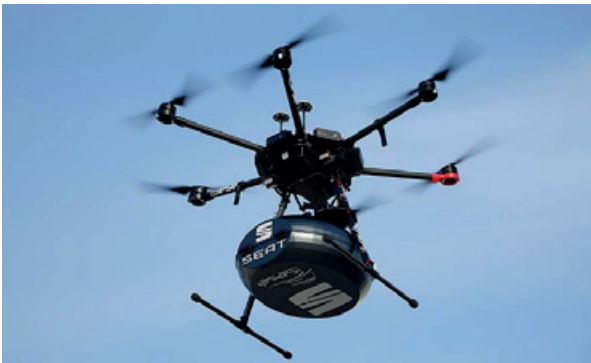
Figura 5: Dron de ocho rotores implementado por SEAT España para entrega de componentes entre dos plantas de producción (Sprovieri, 2021).
