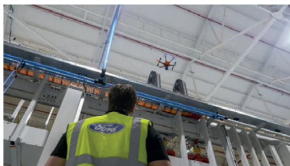
Figura 11: Dron haciendo actividades de inspección en la Ford Dagenham Engine Plant, (Anthony, 2018)
