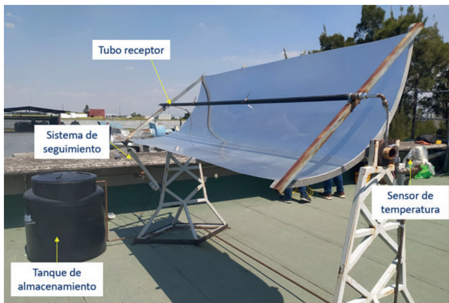
Figura 1. Concentrador cilindro parabólico, elaboración propia.
