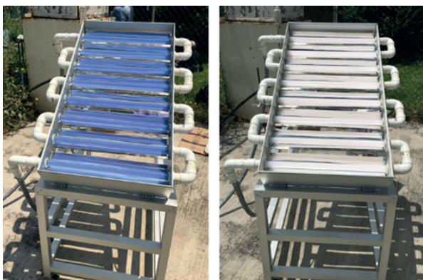
Figura 6. Imágenes de coloración de solución de NR5 al inicio y después de 2.5 h de tratamiento por fotocatalisis.
