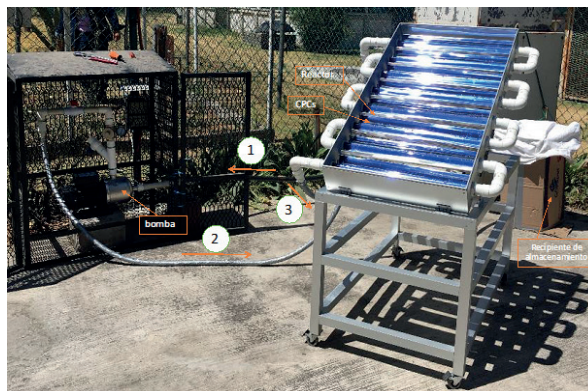
Figura 5. Reactor fotocatalítico con CPC a nivel piloto empleado en la degradación de colorante textil NR5.
