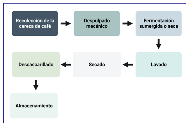
Figura 3. Operaciones básicas del beneficio húmedo del café
