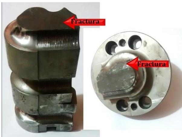
Figura 2: Herramental fracturado en la base.
