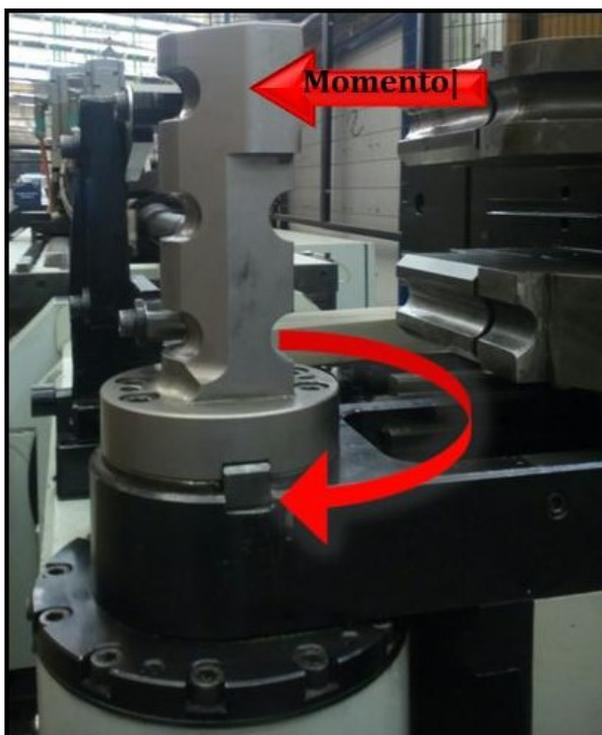
Figura 1: Herramental para el doblado de tubos en operación.
