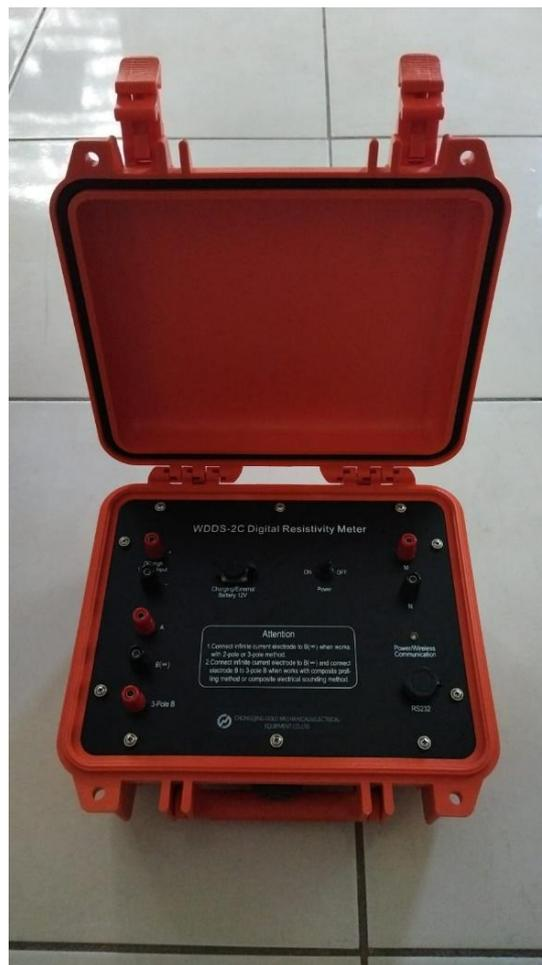
Figura 4: Resistivímetro utilizado para los SEV.
