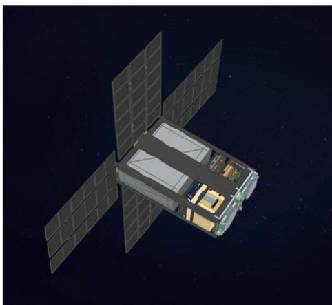
Figura 4: Diseño de satélite para la misión Minerva (tomado de Klomchitcharoen *et al.*, 2022).
