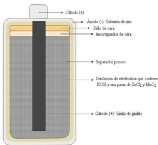
Figura 2. Esquema de un dispositivo de almacenamiento de energía primario
