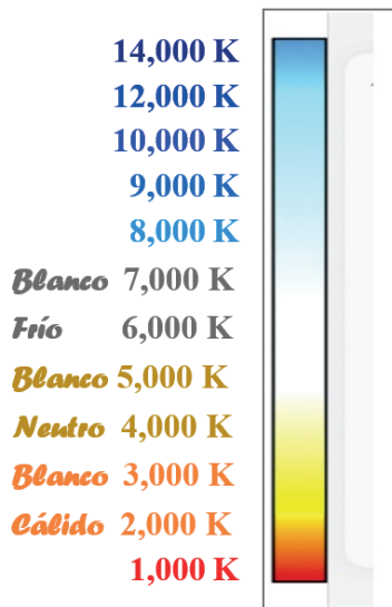
Figura 2. Temperatura de color correlacionada de la luz emitida por un cuerpo negro.
