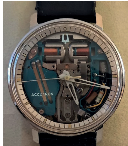
Figura 3. Fotografía de un Accutron Spaceview 214 fabricado en 1965. Puede apreciarse el diapasón con sus dos copas y bobinas en la parte superior, así como parte del engranaje en la zona central. Incluso las manecillas fueron diseñadas para no tapar el mecanismo. Del lado derecho se distingue parte del circuito electrónico; una resistencia con franjas de colores y el transistor arriba de ella.
