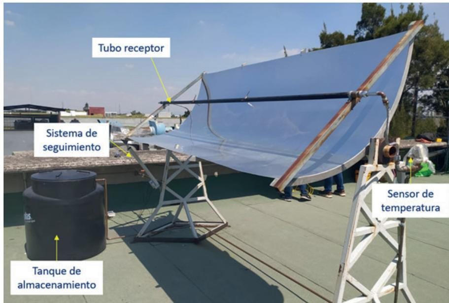
Figura 1. Concentrador cilindro parabólico, elaboración propia.
