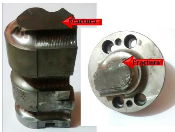
Figura 2: Herramental fracturado en la base.
